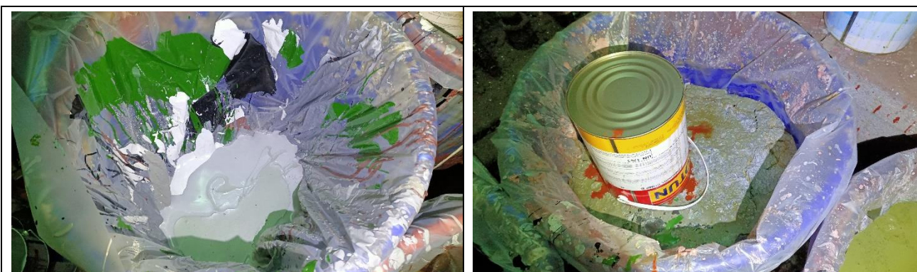
照片說明：廢油漆倒入回收桶內，乾固後用太空包集中運送至安全衛生課秤重。
